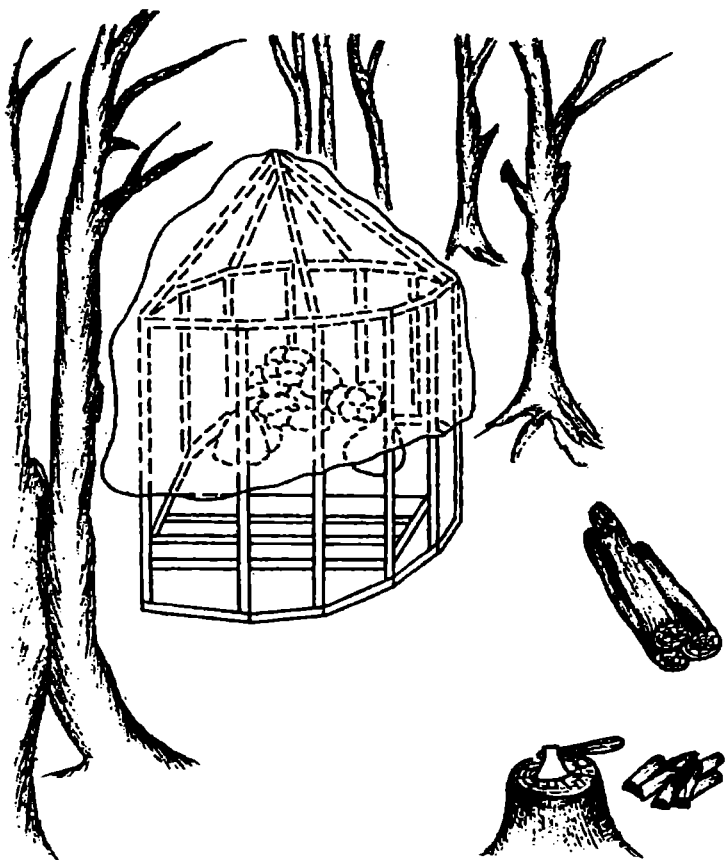
Рис. 48. Простейшая конструкция бани в походных условиях: деревянный каркас, обтянутый пленкой
